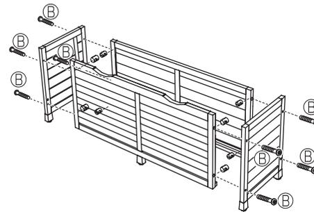
**2** Front- und Rückwandelement mit den Seitenwandelementen zusammenfügen, verwenden Sie dafür Schraube B
