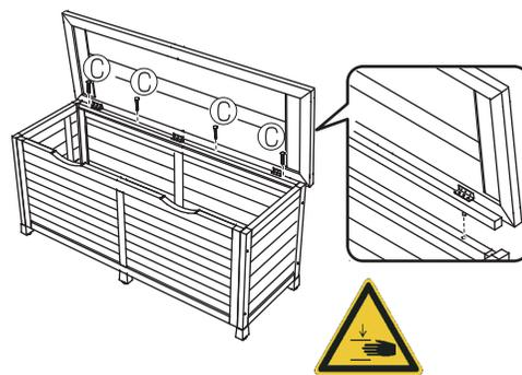
**4** Befestigen Sie das Deckelement mit Schraube C im Rückwandelement
