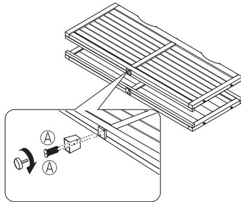
**1** Standfüsse gem. Zeichnung mit Schraube A mittig unten im Bodenbereich des Front- und Rückwandelements befestigen
