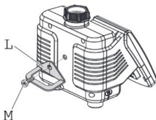
Um den Bewässerungscomputer gegen Diebstahl zu sichern, kann die **GARDENA Diebstahlsicherung Art.-Nr. 1815-00.791.00** über den GARDENA Service bezogen werden.
