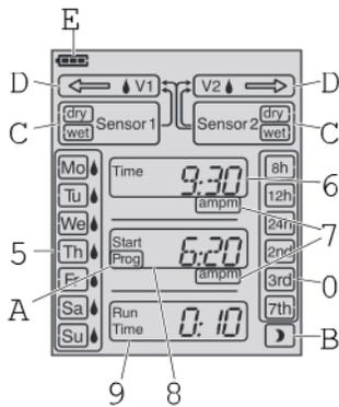
Die Anzeige-Ebene kann jederzeit durch Drücken der **Menu**-Taste gewechselt werden. Alle Programm-Daten, die bis dahin geändert und mit der **OK**-Taste bestätigt wurden, werden gespeichert. Wenn während einer programmierten Bewässerung geänderte Daten mit der **OK**-Taste bestätigt werden, wird das Ventil geschlossen.
