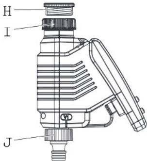
Der Bewässerungscomputer ist mit einer Überwurfmutter **I** für Wasserhähne mit 33,3 mm (G 1")-Gewinde ausgestattet. Der beiliegende Adapter **H** dient zum Anschluss des Bewässerungscomputers an Wasserhähne mit 26,5 mm (G 3/4")-Gewinde.
