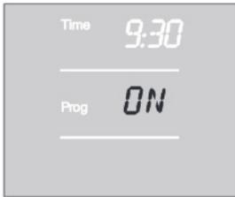
Damit das Bewässerungsprogramm ausgeführt wird, muss zur Aktivierung **Prog ON** gewählt sein. Bei **Prog OFF** wird die automatische Bewässerung deaktiviert. **Prog ON/OFF** kann für jedes Ventil unabhängig gewählt werden. Auch bei **Prog OFF** kann manuell bewässert werden.
