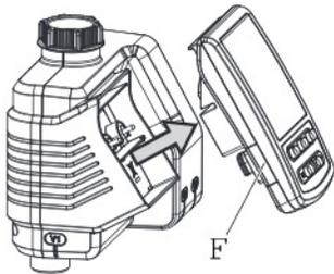
Der Bewässerungscomputer darf nur mit einer 9 V Alkali-Mangan (Alkaline) Batterie Typ IEC 6LR61 betrieben werden.
