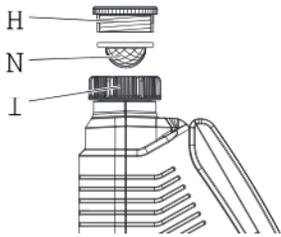
1. Überwurfmutter I des Bewässerungscomputers von Hand vom Gewinde des Wasserhahns abschrauben (keine Zange verwenden).
