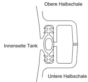
Zur Verbindung der Schalen werden die Schnellverbinder abwechselnd nach rechts und nach links angebracht. Dazu wird im ersten Schritt jeder zweite Verbinder von Hand vorjustiert und anschließend mit einem Hammer und einer Holzunterlage befestigt. Zur leichteren Montage sollten die Verbinder an den Innenkanten eingefettet werden. Die Verbinder rasten in der Endposition ein.
