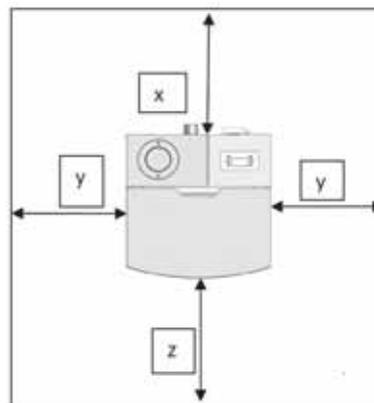
Neben den reinen Sicherheitsmindestabständen muss die Möglichkeit gegeben sein, dass normale Reinigungs- bzw. Wartungsarbeiten ausgeführt werden können. Es sind daher folgende Mindestabstände für Wartungs- und Reinigungsarbeiten einzuhalten:
