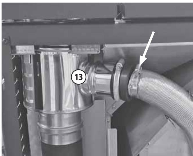
Die eben gelöste Schlauchschelle wird im Anschluss für die Befestigung des Alu-Flexschlauches an dem montierten Anschlussstutzen benötigt.
