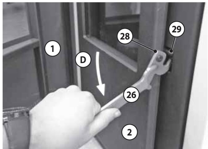
Achten Sie darauf, dass die **Brennraumtür (2)** nach dem Verriegeln dicht am Gerätekorpus anliegt!
