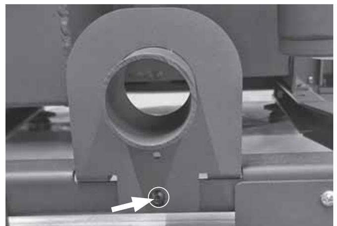
Im Auslieferungszustand erhält das Gerät die zur Verbrennung notwendige Luft über die ringförmige **Verbrennungsluft-Ansaugöffnung (13)** um den **Rauchrohrstutzen (12)**.
