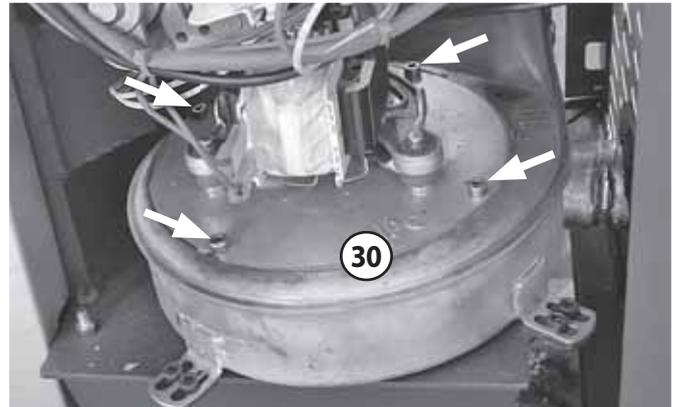
Achten Sie bitte darauf, beim Herausnehmen des **Abgasventilators (30)** Anschlusskabel und Flügelrad nicht zu beschädigen!
