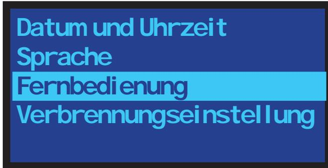
Das Gerät kann über eine Fernbedienung (Lieferumfang) fernbedient werden (→ Kapitel 8.9). Die Empfangseinheit ist bereits im Gerät integriert und kann im Hauptmenü aktiviert bzw. deaktiviert werden.
