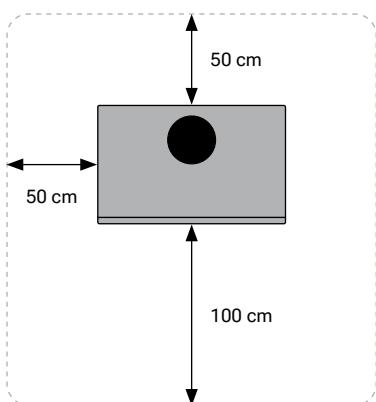
Les revêtements de sol combustibles doivent être protégés sur toute leur surface par un matériau réfractaire. En outre, ce matériau doit être posé à au moins 80 cm de la face avant et à au moins 60 cm sur les côtés de la chambre de combustion. Veillez à ce que le sol présente une capacité de charge adaptée au poêle et, le cas échéant, au support.
