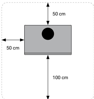
Brennbare Bodenbeläge sind vollflächig durch feuerfestes Material zu schützen. Zusätzlich muss dieses Material mind. 80 cm zur Vorderseite und mind. 60 cm seitlich des Brennraumes verlegt werden. Achten Sie darauf, dass der Untergrund eine zum Ofen und ggf. Unterstell passende Tragfähigkeit aufweist.
