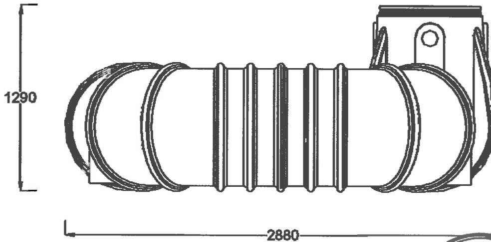
Abflusslose Sammelgrube aus Polyethylen PE-LMD
